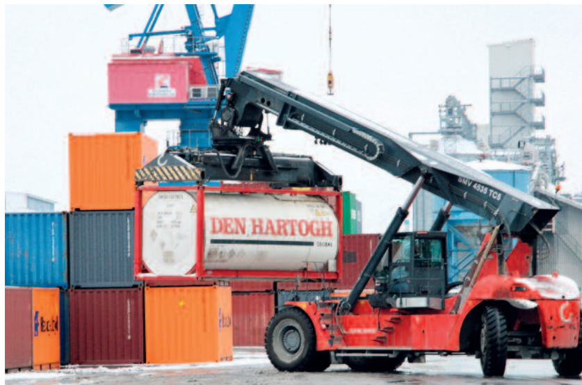
Zum Be- und Entladen der Containerzüge kommen derzeit Reachstacker zum Einsatz. Für das neue Terminal werden Ladekräne beschafft. Sie können die Container sowohl zwischen Gleis und Straße als auch Gleis, Straße und Schiff bewegen. Foto: A.K.
