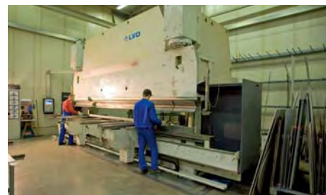
Dank eines komplett CNC-gesteuerten Maschinenparks, zu der auch diese Abkantpresse gehört, können Bleche bis sechs Meter Länge verarbeitet werden.
