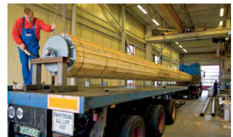
Die Produktionshalle ist mit zwei Fünf-Tonnen-Krananlagen ausgerüstet. Hier wird ein 17 Meter langes Tor für den Transport in die Schweiz verladen. Fotos: Mike Lorenz
