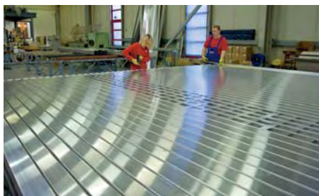
Nach der Fertigung der Einzellamellen in der Profilwalzanlage werden diese zu einem Tor zusammengebaut. Alles erfolgt nach einem einheitlichen Baukastenprinzip.
